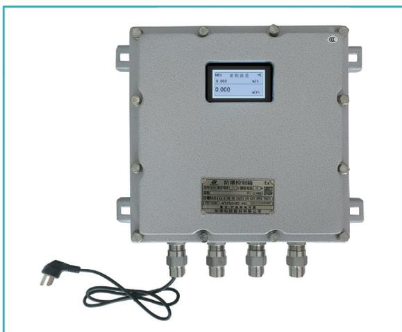
LRF-3000SD是一款防爆固定壁挂式超声波流量计，能够抵抗爆炸的冲击力和热量而不受损失仍能正常工作。超声波流量测量是通过测量上下游传输时差从而获得管道内流速一种测量方式，其优势主要在于可以在不破管，不停水的情况下，通过安装外夹式传感器测量上下游传输信号的发射接收时间差的从而获得准确的流量数据。
