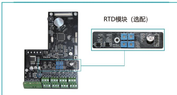
LRF-3000SD 可以搭配使用RTD模块与PT1000 温度传感器，成为计量供热管道、空调制冷管路的热、冷量消耗的能量表；PT1000采用高温电阻线，进口机芯，无论灵敏度还是工况耐用性较国产普通PT100高很多。
